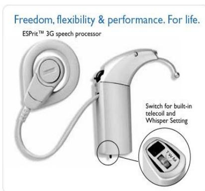
**Рис. 63. Внешний вид звукового процессора «ESPririt 3G», переключатель «Т-W-M», где «Т» - телефонная катушка, «W» - шепот и «М» - микрофон.**
