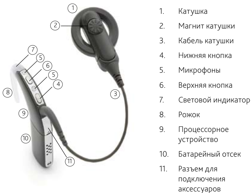
Рис. 1: Элементы звукового процессора CP810
